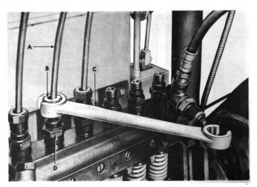
A -- DELIVERY TUBE B-- DELIVERY TUBE NUT C-SPECIAL WRENCH D-VALVE HOLDER
