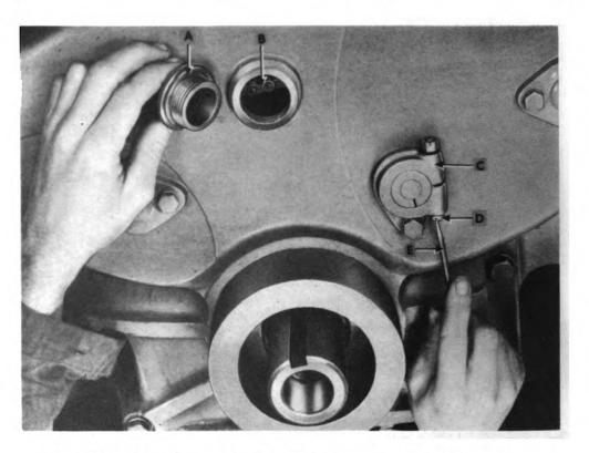
A-INSPECTION PLUG B-CHAIN C-SUPPORT BRACKET D-ADJUSTING SCREW
