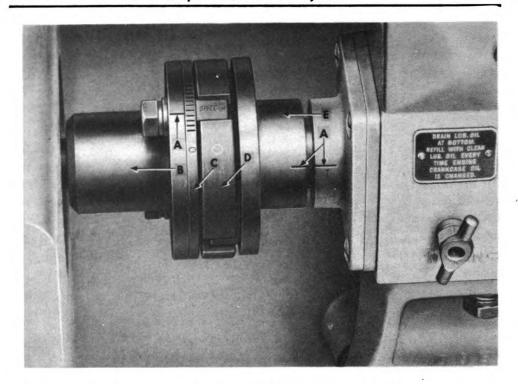
A-TIMING MARKS B-FRONT HUB C-ADJUSTABLE SLOTTED FLANGE D-FLANGE DISK E-REAR HUB
