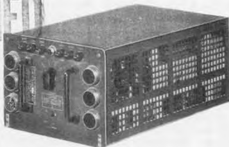
Rectifier Power Unit PP-55/ARQ-9
