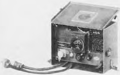
Rectifier Battery Charger PP-116/UPN-1
