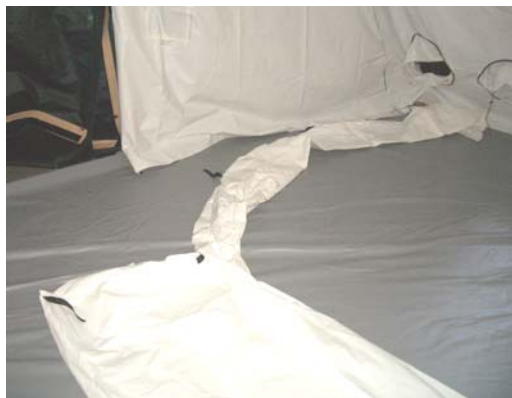
Figure 17. Lay Out Plenum.
