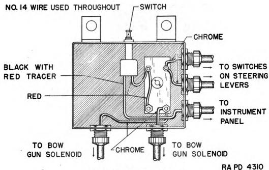
FIGURE 66 .- Bow gun relay box.
