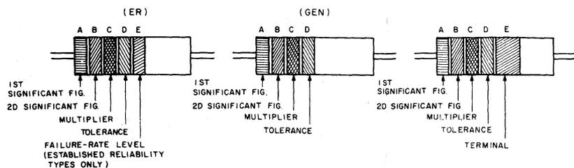
COLOR CODE MARKING FOR COMPOSITION TYPE RESISTORS.
