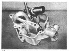
29. DISCHARGE SPRING AND PLUG INSTALLATION
