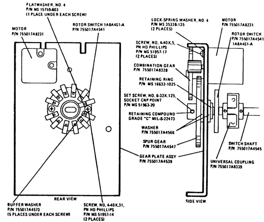
BANDSWITCH GEAR ASSEMBLY 1A8A4, PN 755017A4540
