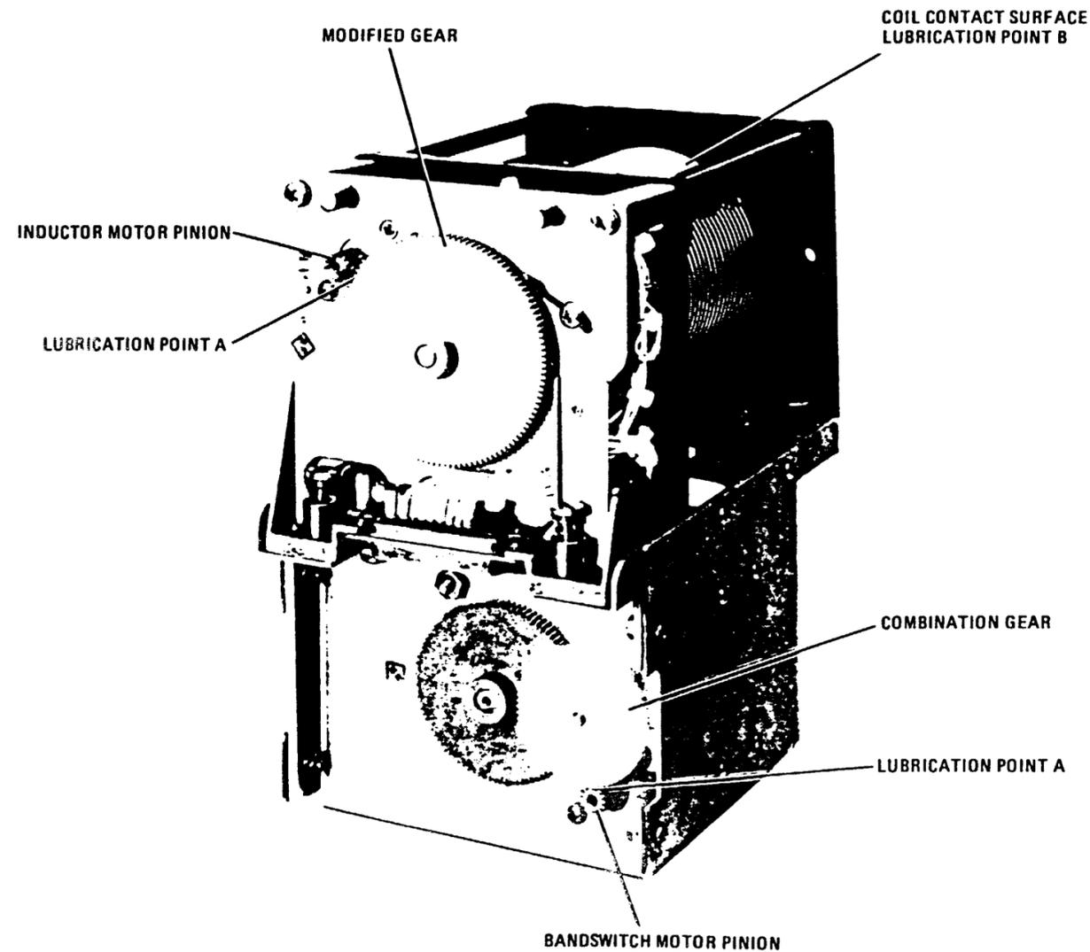
TANK CIRCUIT MODULE ASSEMBLY 1A8
