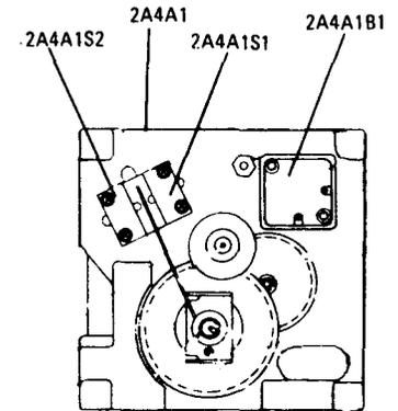
REAR VIEW OF CAPACITIVE GEAR DRIVE ASSEMBLY 2A4A1
