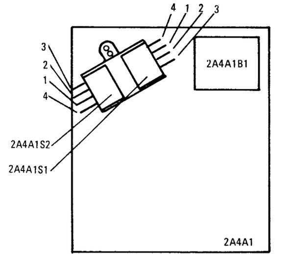
REAR VIEW OF CAPACITIVE DRIVE ASSEMBLY 2A4A1
