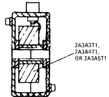
TORROID ASSEMBLIES 2A3A3, 2A3A4, AND 2A3A5 DETAIL VIEW
