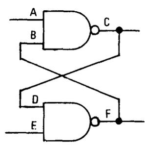
**FLIP-FLOP TRUTH TABLE USING NAND GATES**
