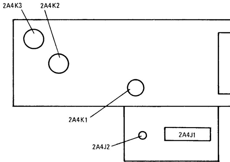
BOTTOM VIEW - CAPACITIVE RF TUNER ASSY 2A4
