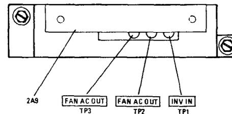
2A9 STATIC INVERTER POWER ASSY - TOP VIEW
