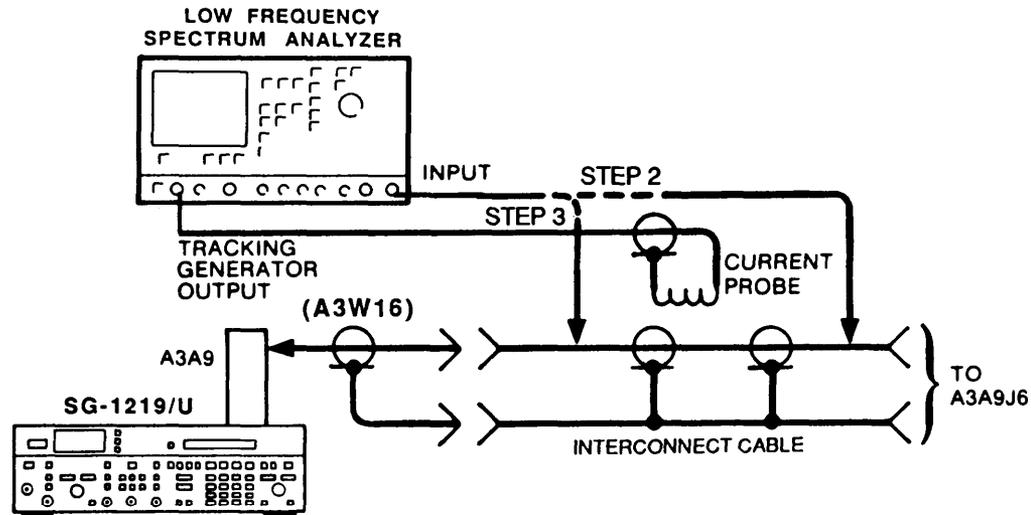
3. On Low Frequency Spectrum Analyzer:
